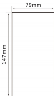
Рис.2.6- Размеры под монтажное отверстие для панели управления ( \geq 30 кВт)
